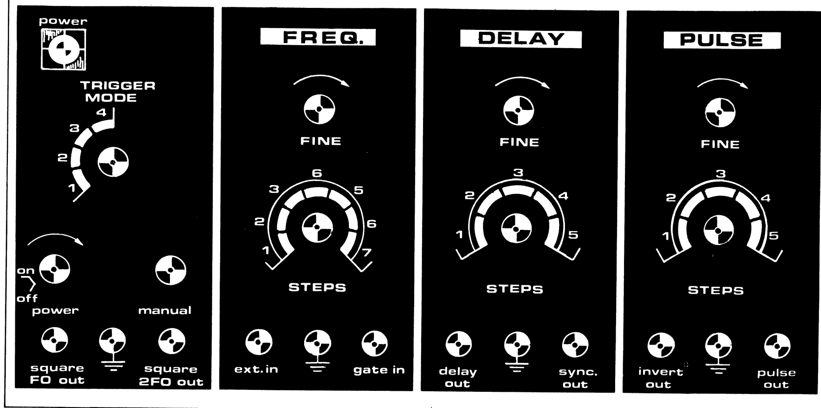
Figuur 4. Een schets van de mogelijke indeling van een frontpaneel voor de generator.
